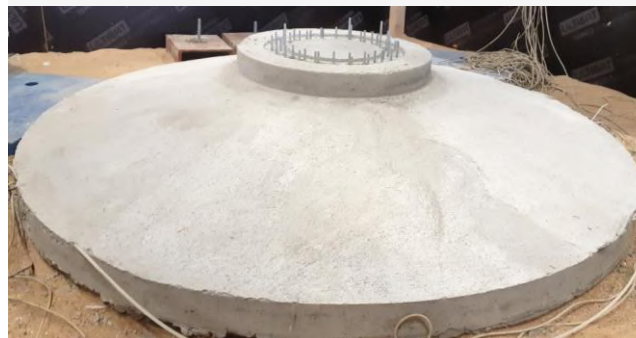
Maquette de fondation à l'échelle 1/10. Essais réalisés à l'INSA de Lyon.
